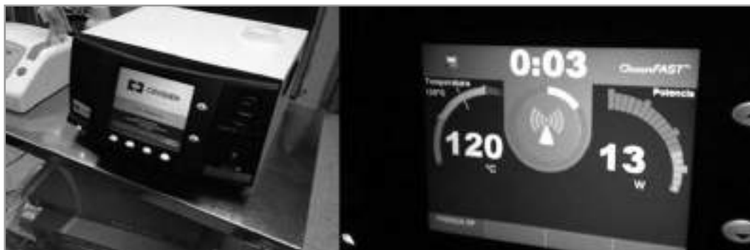
Figura 1. Generador sistema ClosureFast. Detalle de la pantalla en la que se puede observar la temperatura, la potencia y el tiempo restante de tratamiento.
